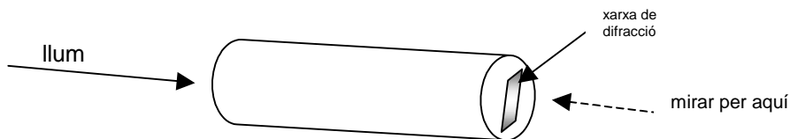
Figura 1. Espectroscopi de butxaca
